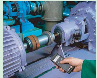
인쇄기 롤러 또는 제조업체의 컨베이어 벨트 rpm 측정
